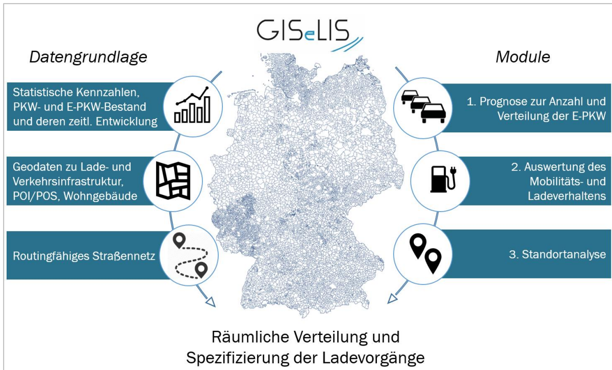
Abbildung 9: Funktionsweise des Standortmodelles für LIS GISeLIS
